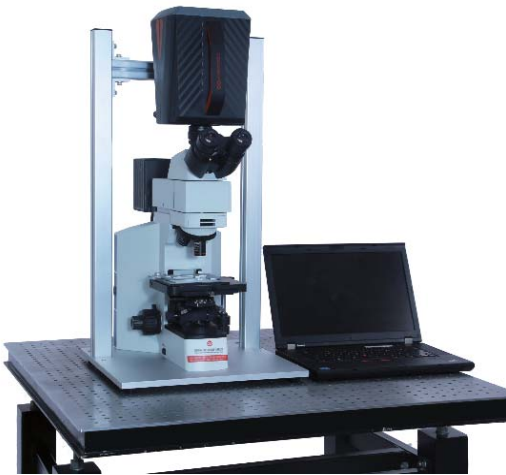
图 可见-近红外显微高光谱系统
