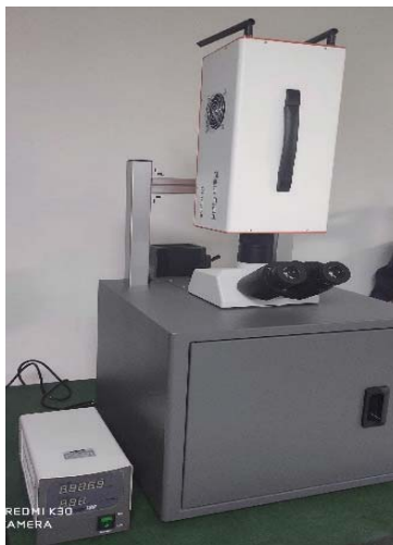
图 显微荧光高光谱系统
