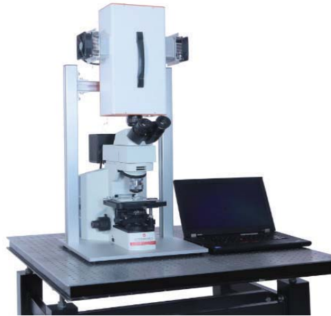
图 近红外二区显微高光谱系统
