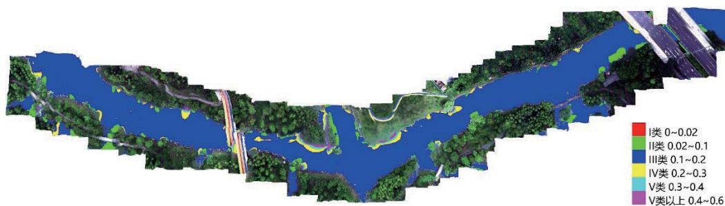
图4 无人机光谱成像指数分析仪评判河湖水质等级
